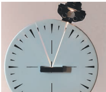
Рис. 11.3. С изменением угла падения света изменяется и угол отражения. Угол отражения всегда равен углу падения
