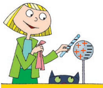
Рис. 5.1. В результате действия электрического поля отрицательно заряженной палочки ближняя к ней часть проводящей сферы приобретает положительный заряд
