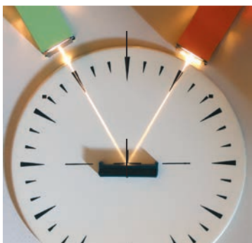
Рис. 11.5. Демонстрация обратимости световых лучей: отраженный луч идет по пути падающего луча
