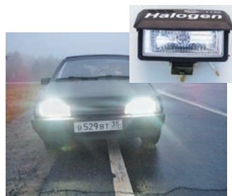
Рис. 9.2. Мощные источники искусственного света — галогенные лампы в фарах современного автомобиля
