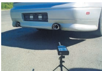
Рис. 5. Измерение уровня шума от глушителя автомобиля
