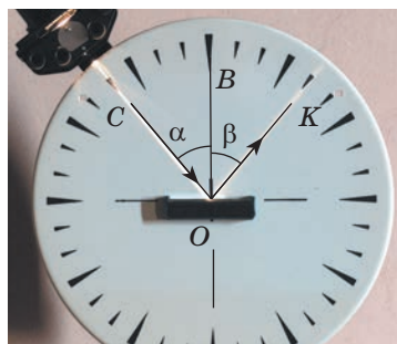
Рис. 11.2. Установление законов отражения света с помощью оптической шайбы: \alpha — угол падения; \beta — угол отражения
